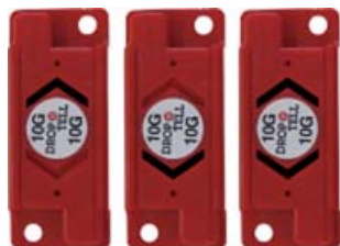
Изображение 3-5 Сработавший индикатор столкновений
