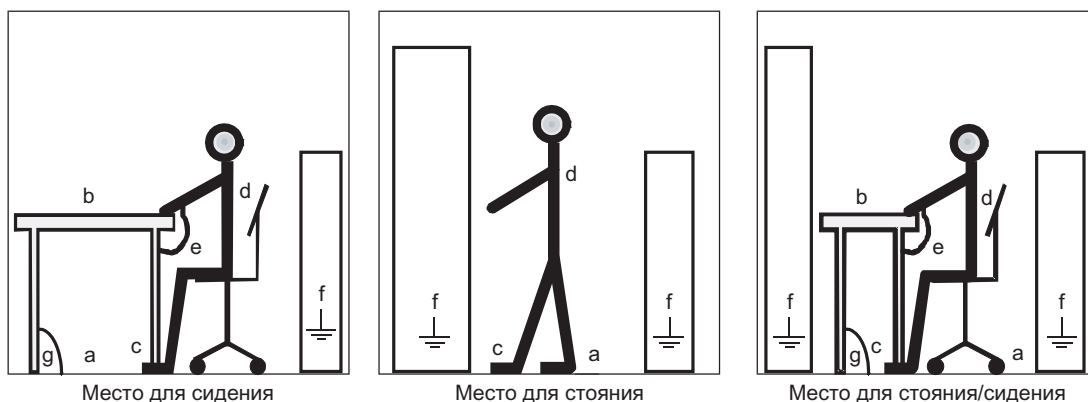
Изображение 1-1 Меры по защите элементов, подверженных опасности разрушения в результате электростатического заряда
