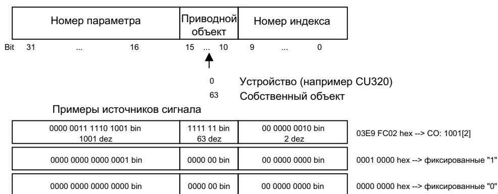
Изображение 6-6 Внутренняя кодировка параметров бинекторных/коннекторных выходов
