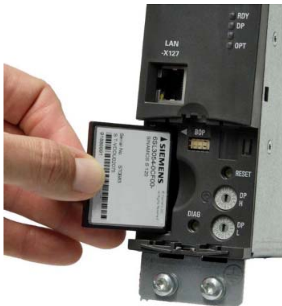
Изображение 4-50 Слот для карты CompactFlash
