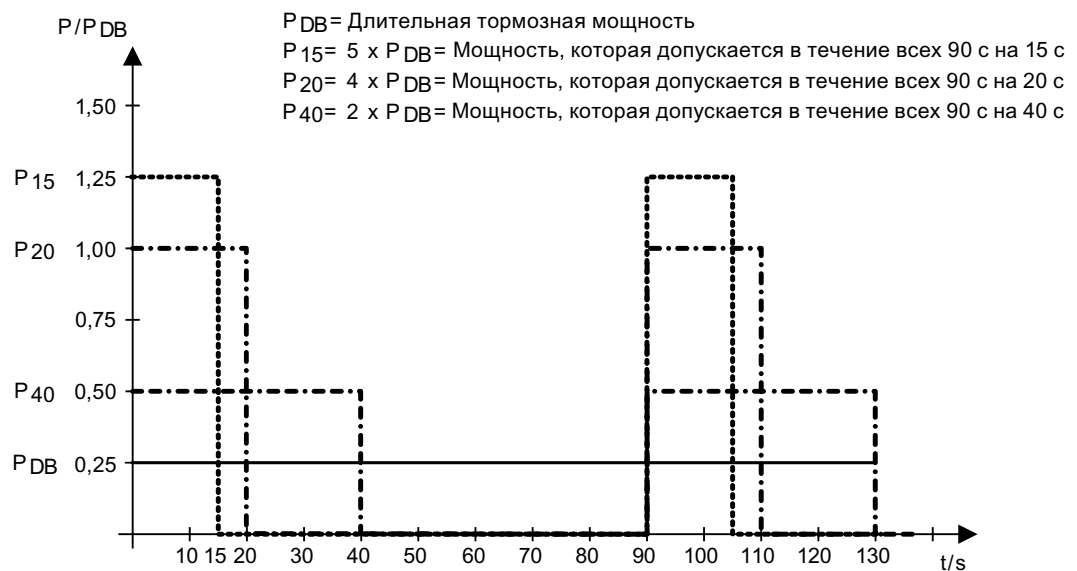
Изображение 4-23 Нагрузочные циклы тормозных сопротивлений
