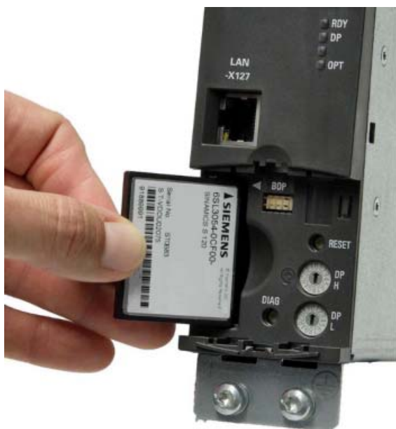
Изображение 4-15 Слот для карты CompactFlash
